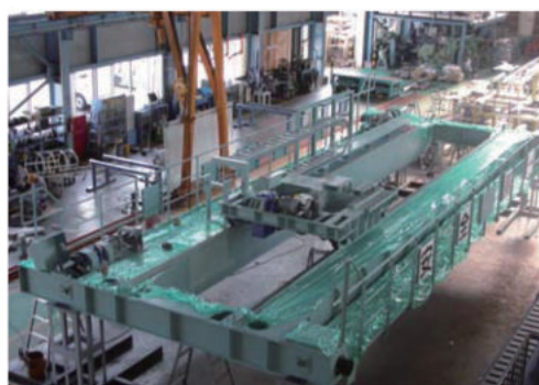
ダブルレール形ホイスト式天井クレーン (7.5t×11.68m)
