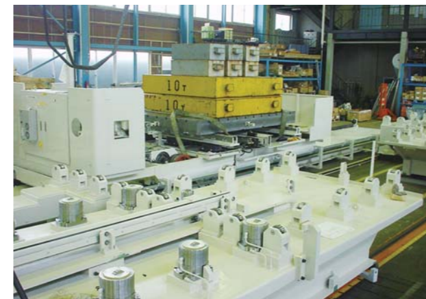
加工用ワーク自動搬送システム (搬送荷重30t)
