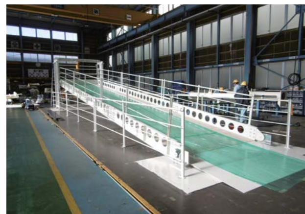
走行試験用スロープ (角度可変構造)
