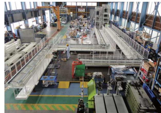
エンジン搬送ライン (中2階設置、歩廊付き)
